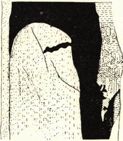
O b r. 7. Zákres stropu; hlavné metasomatické teleso na 12. obzore pri šachte Alžbeta, južná sledná. Bohaté zrudnenie sa koncentruje na styku dacitu so sedimentmi: 1. bohaté metasomatické zrudnenie, 2. slabozrudnelé chloritizované sedimenty, 3. dacit, 4. brekie dolomitizovaných vápencov, 5. kremeň 6. periódy.
