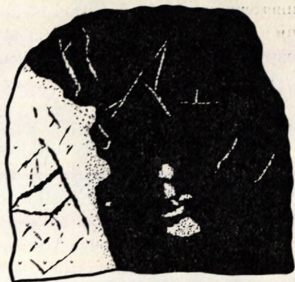
O b r. 6. Zákres čelby; hlavné metasomatické teleso na 12. obzore pri šachte Alžbeta, severná sledná. Bohaté metasomatické zrudnenie na styku s dacitom, v ktorom je vyvinutý žilník 4. periody: 1. bohaté metasomatické rudy, 2. dacit, 3. brekcie pôvodnej horniny (dolomitizovaný vápenec), 4. žilky 6. periody.
